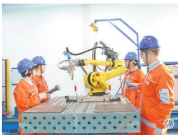
控制系统能够对压力、电流、时间等焊接参数进行实时监控并调整,比人工焊接的质量更稳定。”张文军说。
